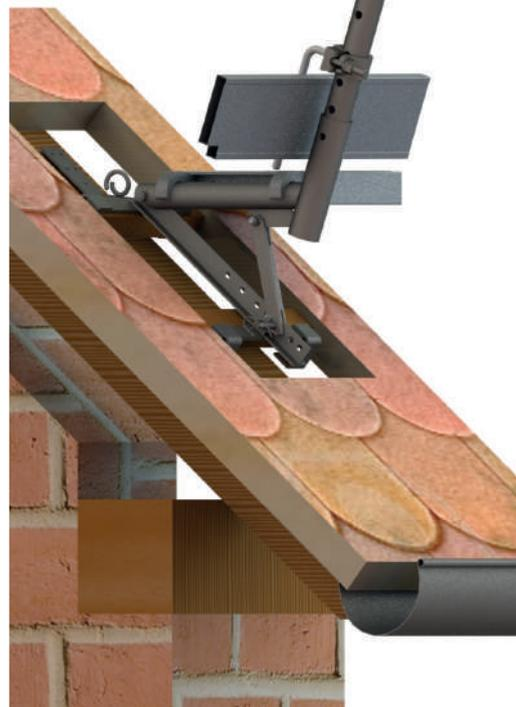
Mensola solare completamente assemblata
