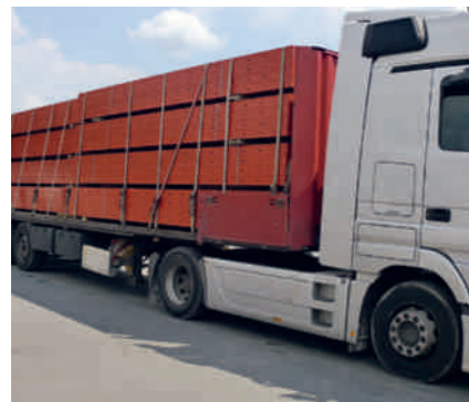
► Geringe Transportvolumen und Lagerkosten aufgrund der geringen Tischbauhöhe von nur 12 cm
